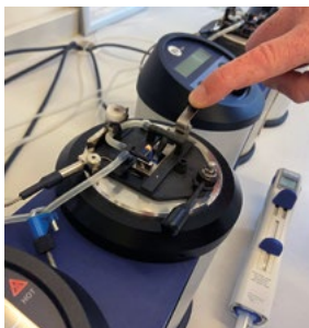
Zündversuch im Setaflash Flammpunkt-Testgerät
